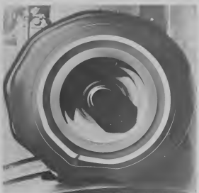
AT THE Atlas lab, tires are run on the "torture wheel" to death at speeds up to 120 miles per hour. DEN LABORATORIO di Atlas, tiranan ta draai ariba e "wiel di tortura" na velocidad di 120 mijl pa ora te ora nan caba.
